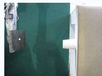
将一次性纸杯固定在支架上，使其与制品前后动作位置有冲突
